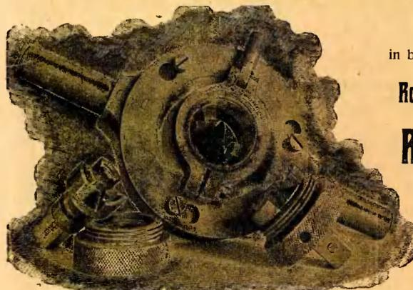
Reinecker-Schneidkluppe in Verbindung mit Rohrfräser.
